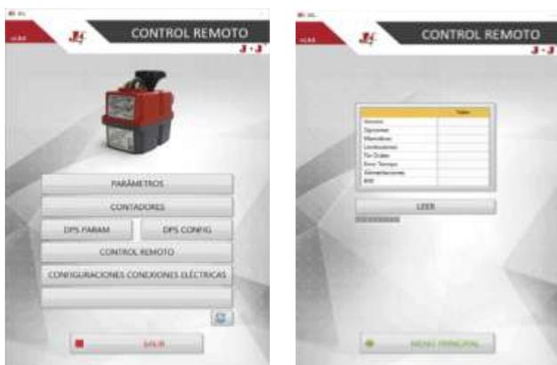
Si presionamos sobre la opción **CONTADORES**, se abrirá la siguiente pantalla con todos los contadores. Para ver los valores presionar **LEER**.
