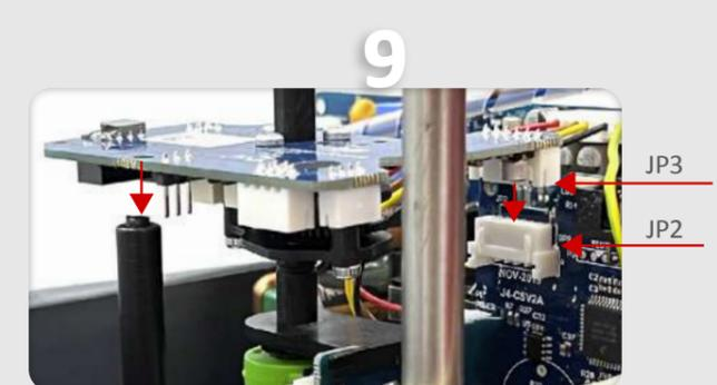
9 Introducirla hasta que el conector de la electrónica DPS (JP3) esté conectado con el conector (JP2) de la electrónica del actuador.
