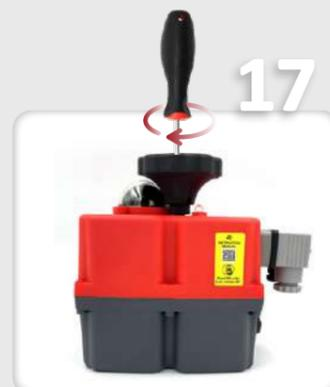
17 Montar y fijar el volante en el eje, haciendo coincidir el perfil del volante con el del eje.
