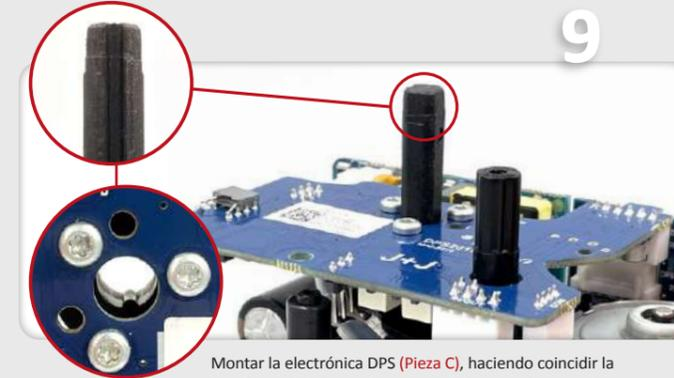
9 Montar la electrónica DPS (Pieza C), haciendo coincidir la hendidura del eje con la chaveta del engranaje central.
