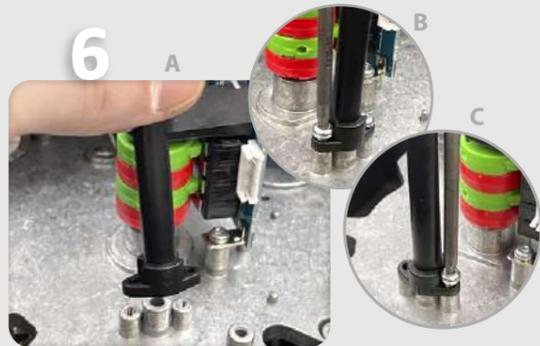
6 Fijar la columna de plástico (Pieza B) a la chapa del actuador (Fig. 7A) mediante 2 tornillos rosca chapa (Pieza D) (Fig. 7B y 7C).
