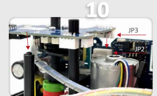
10 Introducirla hasta que el conector de la electrónica DPS (JP3) esté conectado con el conector (JP2) de la electrónica del actuador.
