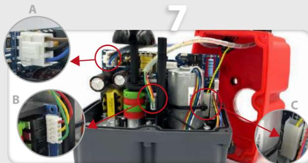
7 Coger la tapa del kit DPS (Pieza A) y conectar el cableado según (Fig. A, B y C).
