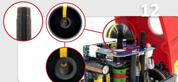
12 Insertar cuidadosamente el indicador visual de posición, haciendo coincidir la chaveta interior con la hendidura del eje.
