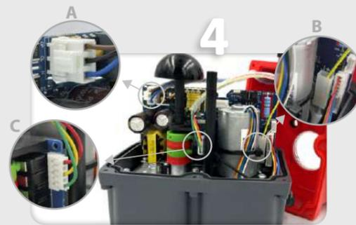
4 Desconectar el cableado de la tapa que está conectado a la electrónica. (Fig. A, B y C).
