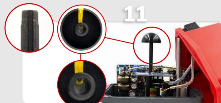
11 Insertar cuidadosamente el indicador visual de posición, haciendo coincidir la chaveta interior con la hendidura del eje.
