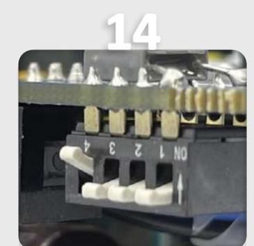
14 Configurar los DIPs, según la señal de instrumentación
