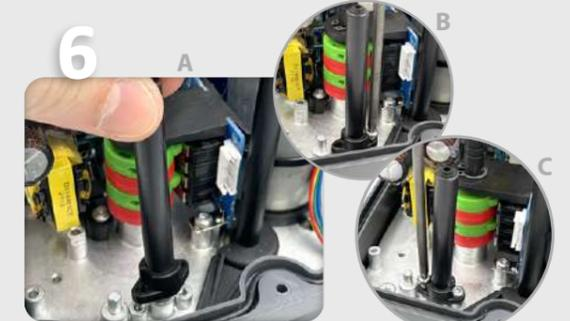
6 Fijar la columna de plástico (Pieza B) a la chapa del actuador, mediante 2 tornillos rosca chapa (Pieza D). (Fig. A, B y C).
