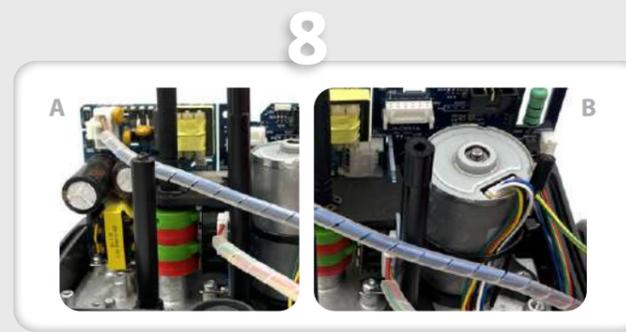
8 Situar el cableado de la tapa, según (Fig. A y B).
