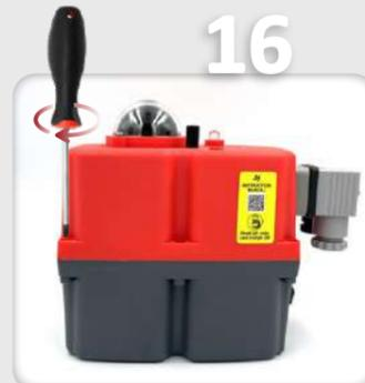
16 Fijar los 8 tornillos de unión entre la tapa y el cuerpo.
